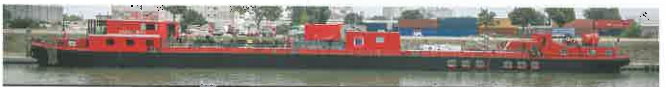
Die MÜB wurde aus einem ehemaligen Tank-Binnenschiff umgebaut.
