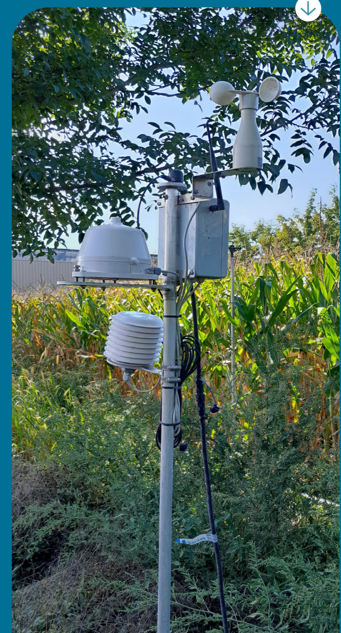
Station météo connectée avec sonde capacitive dans un essai Agroforesterie en grandes cultures - Artolsheim Photo : Chambre d'agriculture, © François Lannuzel
